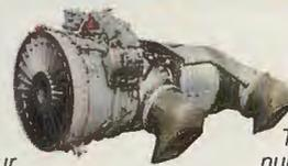
Heart of a Harrier: the jump-jet engine.
