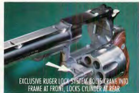
EXCLUSIVE RUGER LOCK SYSTEM BOLTS CRANE INTO FRAME AT FRONT; LOCKS CYLINDER AT REAR
